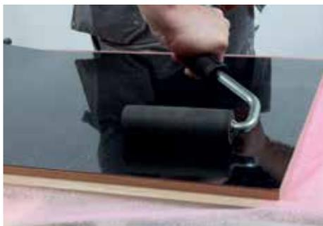
4. Passer fermement le maroufleur sur l'ensemble. Utiliser si nécessaire une presse (temps de pressage : 15 à 30 secondes).
