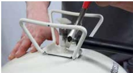
Les connexions entre le flexible sur le canister et le pistolet sont du type connexion gaz sans joint d'etancheite. Ces connexions doivent etre complètement serrees jusqu'a ce que le flexible ne puisse plus tourner sur le couplage.
