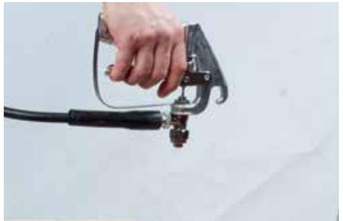
8. Pulveriser avec le flexible jusqu' obtention d'un bon jet.
