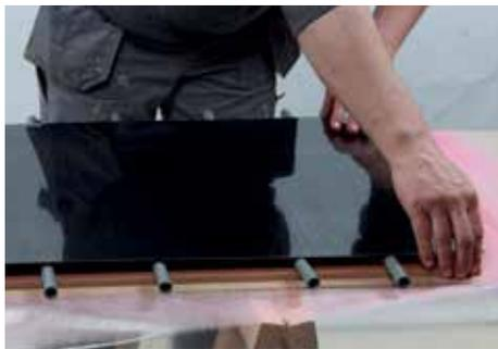
2. Positionner le matériau à fixer sur les tubes en plastique.
