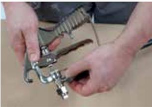
4. Monter le pistolet sur le flexible et serrer fortement
