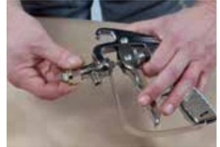
3. Monter la buse desiree sur le pistolet et determiner la position de la buse.
