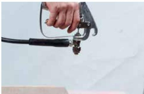
2. Vider complètement le flexible jusqu'à ce qu'il n'en sorte plus de colle, ni de gaz propulseur.
