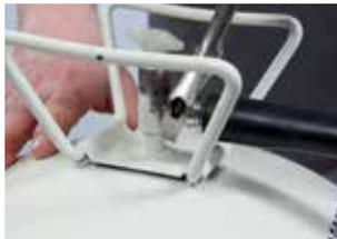
5. Coupler le flexible au canister et serrer fermement
