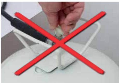
3. NE JAMAIS fermer le robinet du canister. Le flexible doit toujours rester sous pression.
