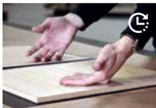
6. Laissez la colle sécher (s'évaporer), le temps de gommage minimum dépendant du type d'adhésif. Contrôlez avec le dos de la main. La couche de colle doit être sèche au toucher. Certaines colles peuvent rester légèrement collantes au toucher.
