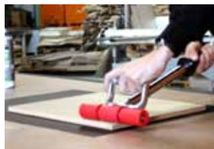
8. Passer fermement le maroufleur sur l'ensemble (presser ou frapper avec un marteau en caoutchouc pendant min. 15 sec est également possible). La pression initiale détermine la force finale, atteinte après 72 heures.
