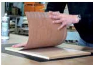
7. Respecter également le temps d'ouverture de la colle. Après le temps de séchage, il reste environ 30 minutes pour bien positionner et fermer l'ensemble définitivement. Après contact entre les deux matériaux, il est impossible de faire des corrections.
