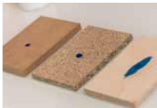
1. Déterminez quel matériau a un haut pouvoir absorbant. Ceci se voit facilement en appliquant de l'encre sur l'arrière du matériau. Dans l'exemple ci-dessus, c'est celui qui se trouve à l'extrême droite.
