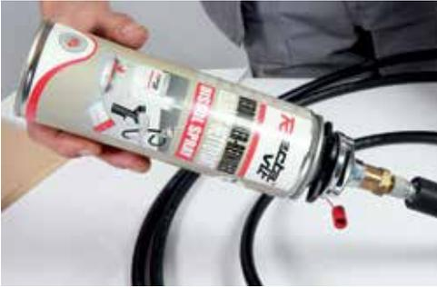
5. Connecter le Cleaning adaptor sur le Dissol Cleaner Spray (le flexible se remplit directement de solvant).
