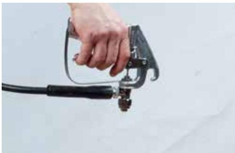
2. Vider complètement le flexible jusqu'à ce qu'il n'en sorte plus de colle ni de gaz propulseur.
